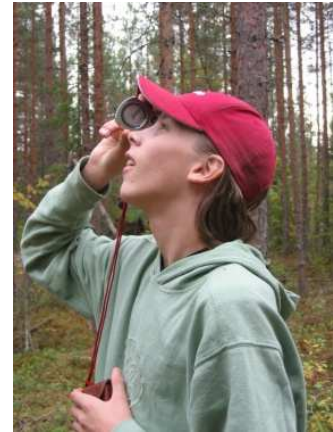
Puun pituutta voidaan mitata hypsometri-nimisellä laitteella.
